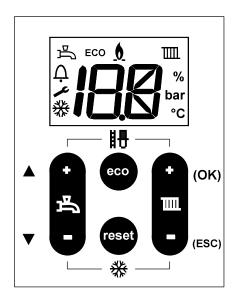
DHW Visible when DHW program is active
